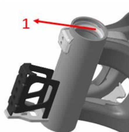
Retire el anillo de retención del cojinete 2 en el vástago de dirección tirando de las herramientas (como se muestra en la imagen)
